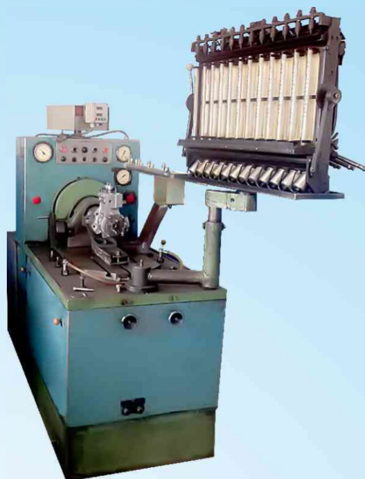
Стенд по обкатке и дозировке ТНВД
