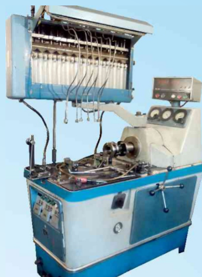
стенд по испытанию ТНВД российского производства
