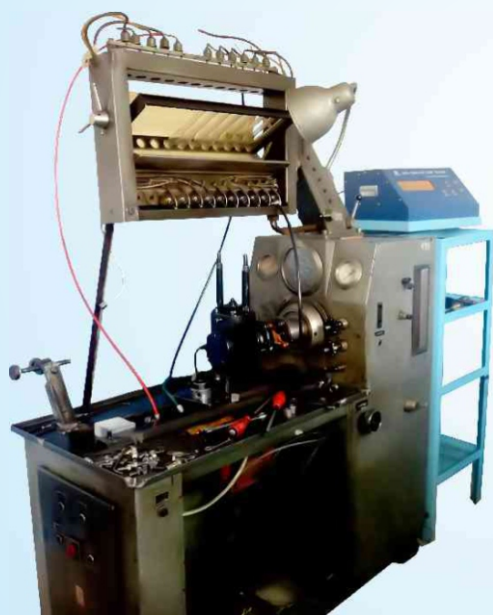
Стенд по обкатке и дозировке электронных инжекторных ТНВД
