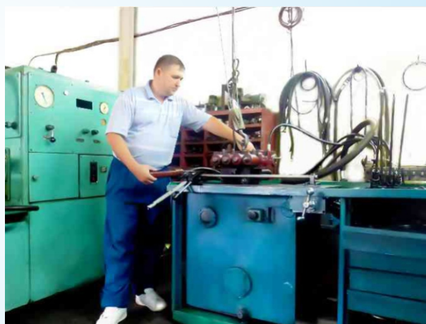
Стенд по испытанию гидравлических распределительных коробов высокого давления всех моделей
