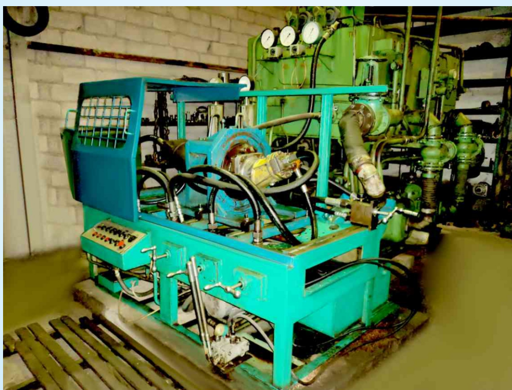
Стенд по испытанию гидронасосов, гидромоторов и различной гидроаппаратуры импортного и российского производства
