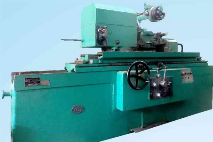
Круглошлифовальный станок по шлифовке гидрозолотников
